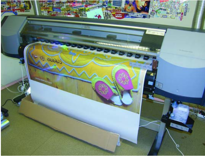
Режим Draft (360x360 dpi) обеспечивает максимальную производительность - почти 15 кв.м/ч
