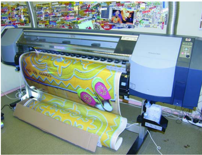
Режим Fine Draft (720x540 dpi) печатает в 4 прохода со скоростью около 10 кв.м/ч
