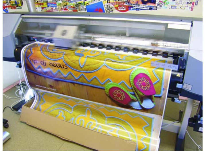
Режим Draft (360x360 dpi) обеспечивает максимальную производительность - почти 15 кв.м/ч
